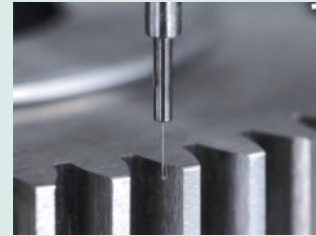
MPP-NANO module (0.8mm taster) met tandwiel meting
