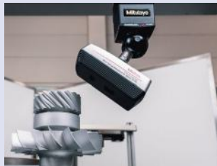
Het "flying" spottype is in staat om moeilijke onderdelen, zoals deze waaier, nauwkeurig te scannen en bereikt de hoogste scannauwkeurigheid in zijn soort.
