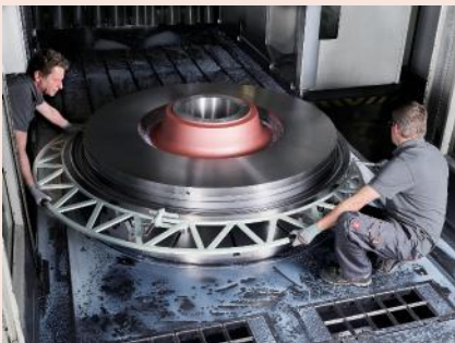
Toepassing met verstelbare aanslag op werkstuk
