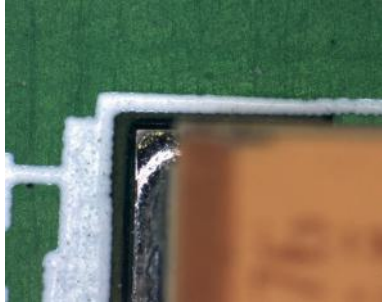
traditionele microscoop (onder) Met een hoogteverschil kan enkel op 1 hoogte gefocust worden.
