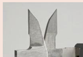
Meetvlakken voorzien van hardmetaal
