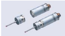
TP200 Compact en hoge nauwkeurigheid (tasterwissel model)
